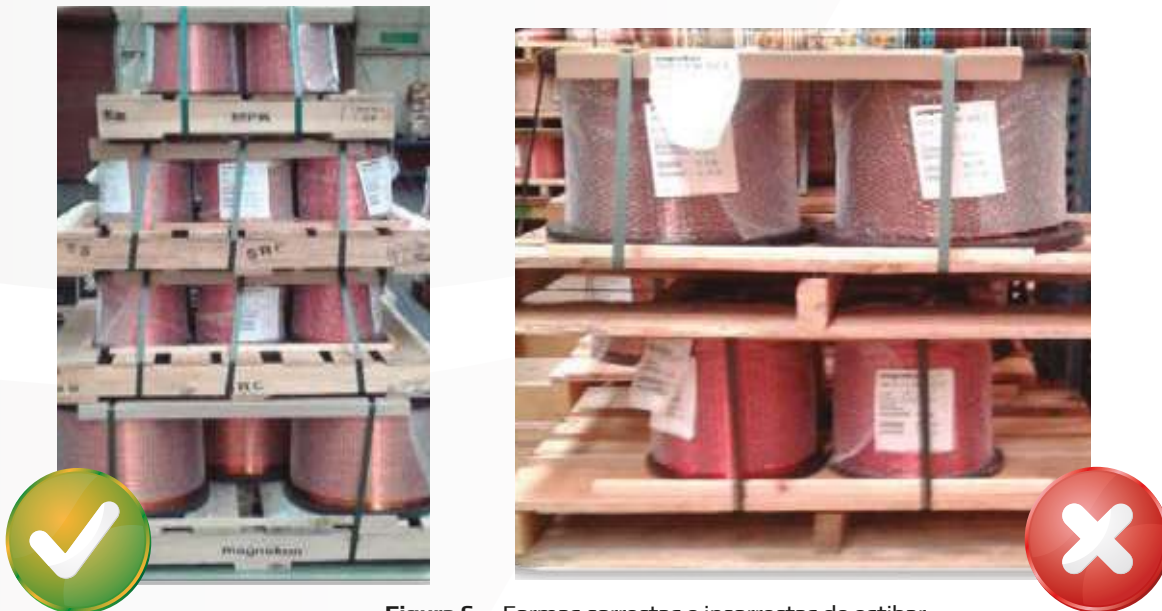
Figura 6 – Formas correctas e incorrectas de estibar.
