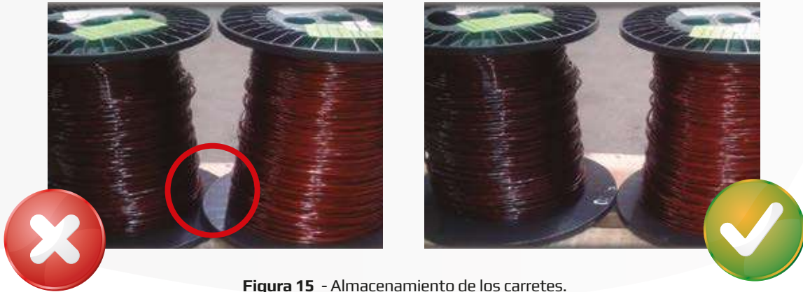
Figura 15 - Almacenamiento de los carretes.
