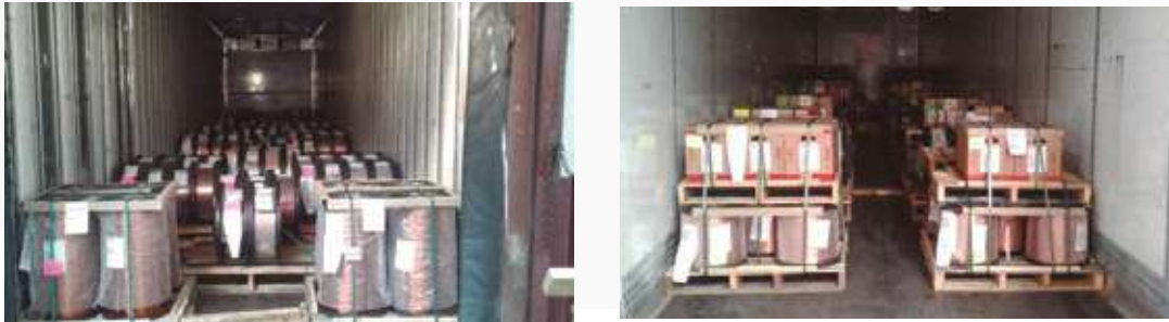
Figura 7 – Correcto acomodo de estibas para el transporte.
